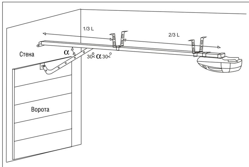
Высота подвеса привода обуславливается максимальным подъемом верхней кромки ворот.
