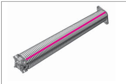
Для упрощения подсчетов оборотов пружины во время монтажа рекомендуется нанести на поверхность пружины краской прямую линию.
